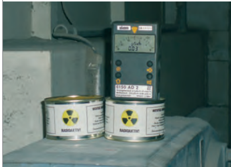
14.5. Strahlenschutz Einsatz in der SLR, Verdacht auf strahlendes Material. In der Sortierung wurden Dosen mit aufgeklebten Strahlenschutzzeichen gefunden. Die Messungen ergaben keine erhöhte Strahlenbelastung und die Dosen konnten als Werbematerial identifiziert werden.
